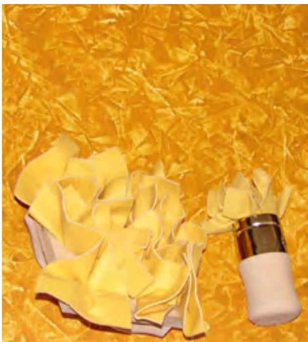
S. D2 Tampone in legno con pelli.
